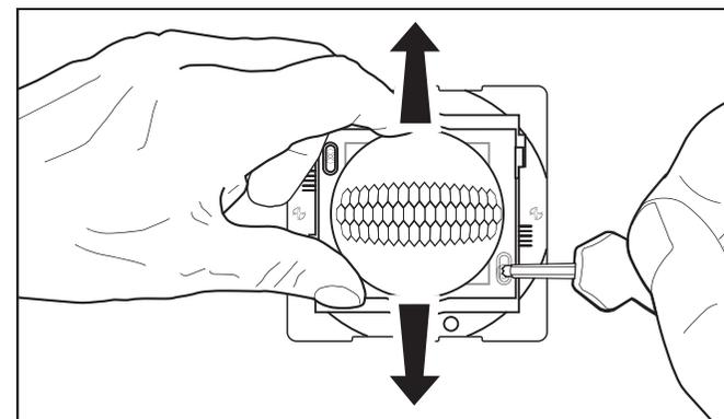
При необходимости можно произвести оптимальную установку зоны обнаружения за счет регулировки линзы. Ослабляем винт отверткой и смещаем линзу вверх, либо вниз.
