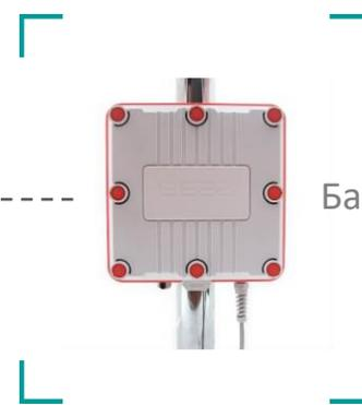
Базовая станция LoRaWAN
