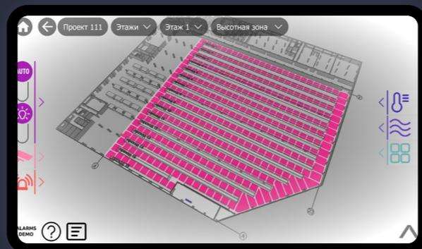
Датчики позволяют компенсировать световой поток светильников в процессе эксплуатации (пыль, деградация, помутнение), в период отсутствия людей в зоне можно включить минимальную яркость. Также возможна настройка освещения по запросу, в привязке к конкретной задаче, в том числе к охранным системам здания.
