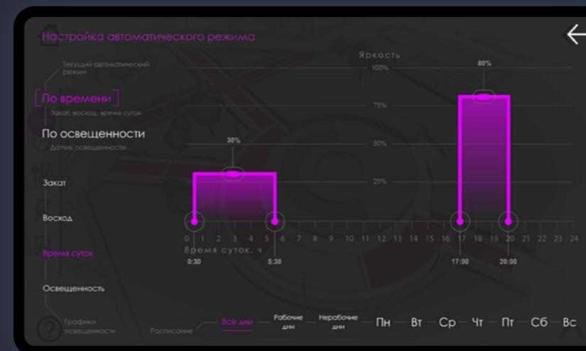
В выходные дни и в дни неплановой работы участков могут быть настроены индивидуальные сценарии работы освещения, включаемые как автоматически, так и вручную с кнопочных постов.
